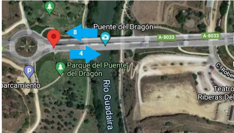
Ilustración 125. Flujos de entrada y salida del Puente del Dragón. Vehículos pesados. Hora punta de mañana
