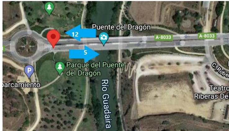
Ilustración 127. Flujos de entrada y salida del Puente del Dragón. Motocicletas. Hora punta de mañana
