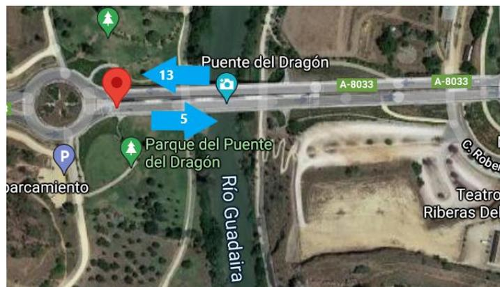
Ilustración 128. Flujos de entrada y salida del Puente del Dragón. Motocicletas. Hora punta de tarde
