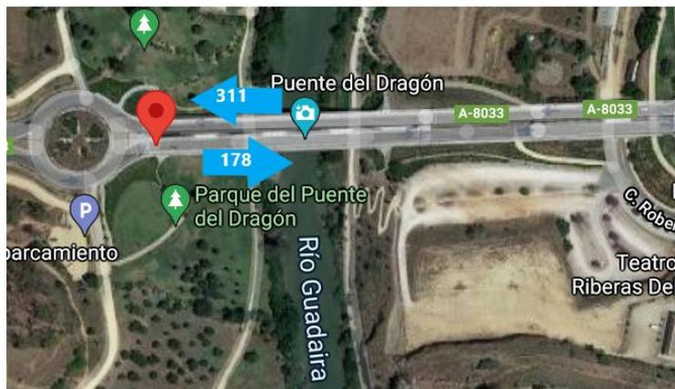
Ilustración 124. Flujos de entrada y salida del Puente del Dragón. Vehículos ligeros. Hora punta de tarde
